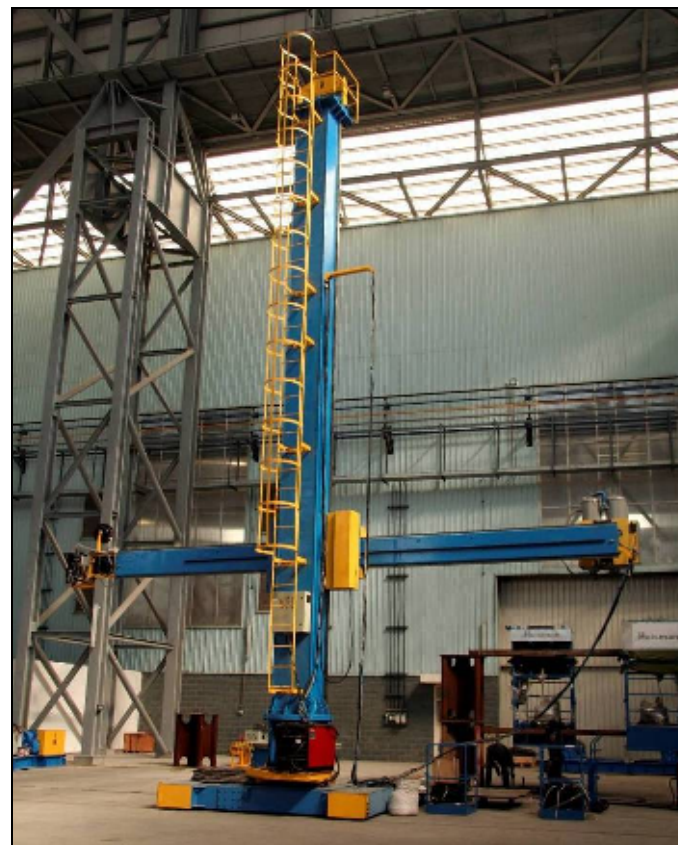
Figura 15. Máquina de soldagem.
