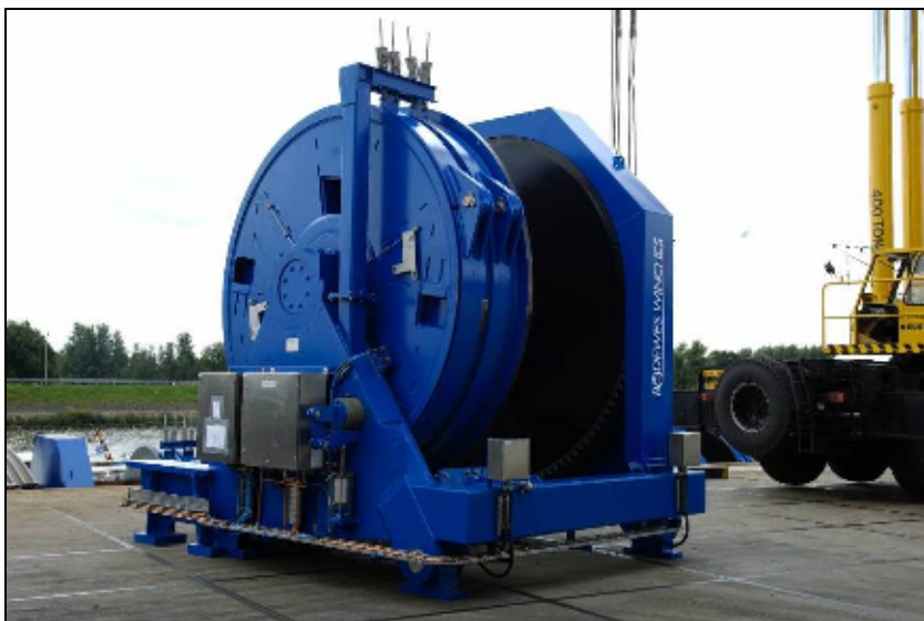
Figura 5. Guincho para manuseio de âncoras a ser produzido durante a Fase I na Unidade Produtiva da Huisman do Brasil , Navegantes, SC.
