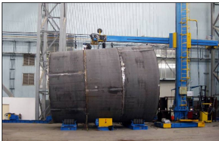
Figura 17. Máquina de soldagem.
