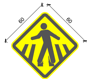
A32-b - TRAVESSIA DE PEDESTRES SINALIZADA
