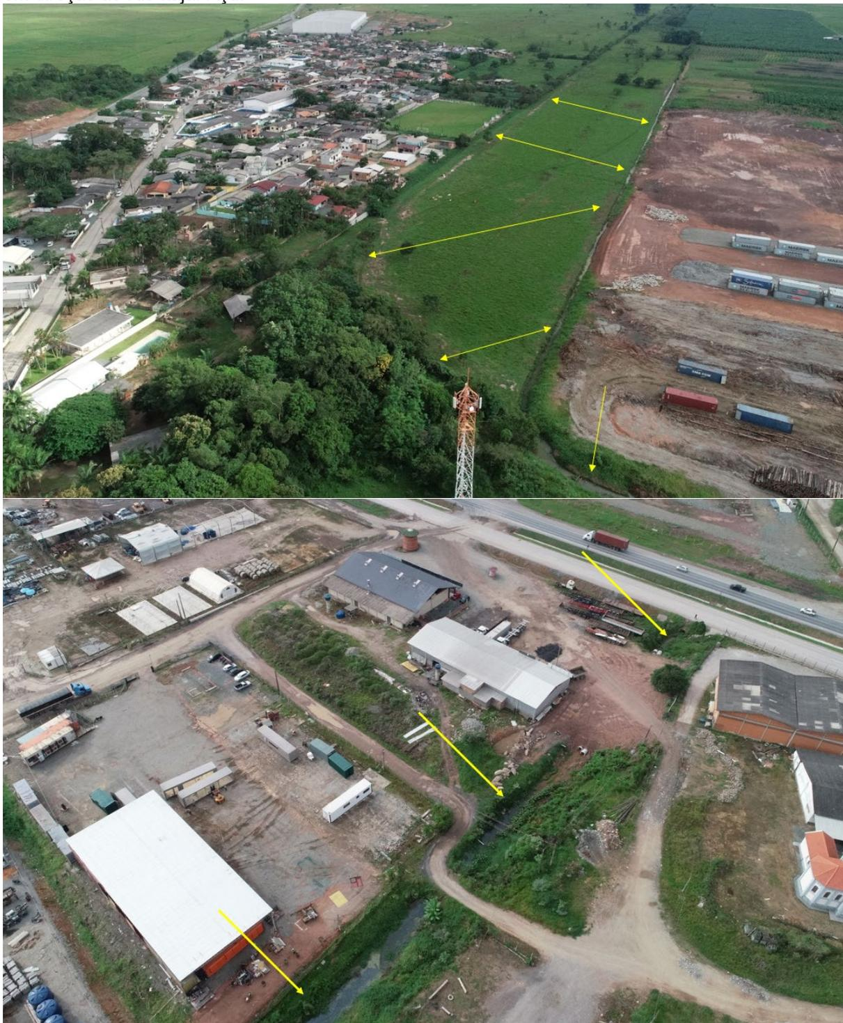
FIGURA 29 – Drenagem pluvial da AID. Sequência da vala onde passa sob a BR 470.
