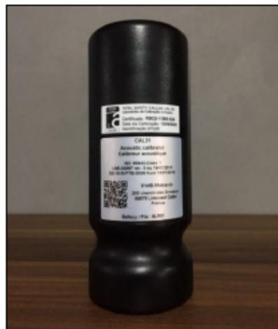
Figura 5: Calibrador acústico modelo CAL31, marca 01dB.
