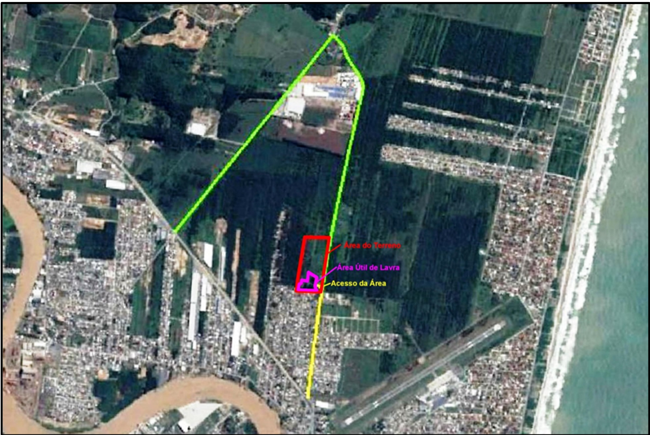
Figura 14: Imagem do trajeto dos caminhões vazios em amarelo pela Rua Francisco de Paula Seara, até a área do empreendimento (magenta), e em verde o trajeto dos caminhões carregados de material na Rua Francisco de Paula Seara, sentido norte, até a Rua Honório Bortolato distribuídos para BR 470 e outras vias. Fonte Google Earth.
