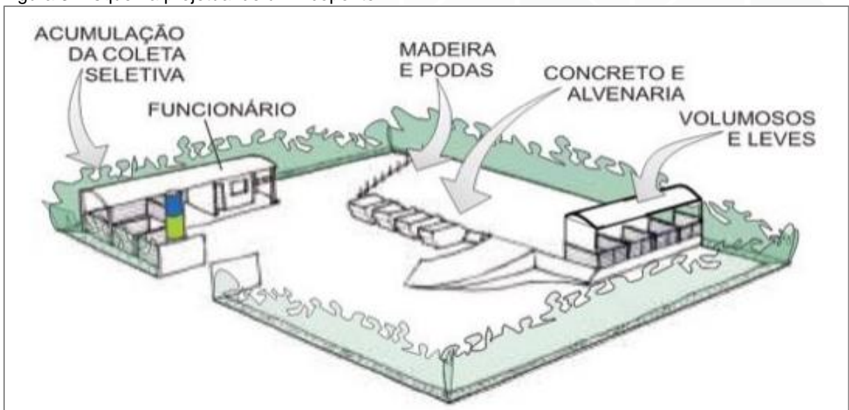
Figura 3: Esquema projetual de um Ecoponto.
