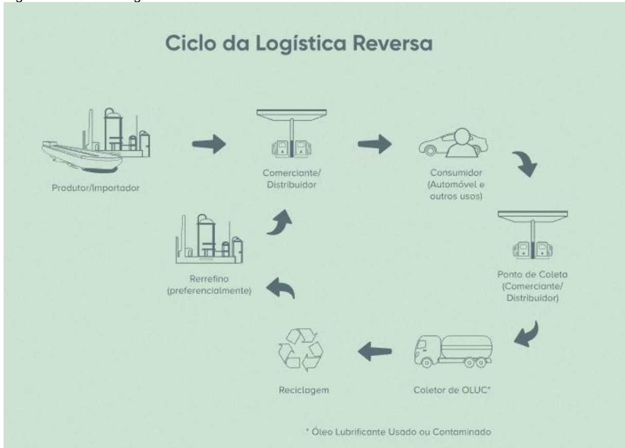
Figura 51: Ciclo da logística reversa dos óleos lubrificantes usados ou contaminados.
