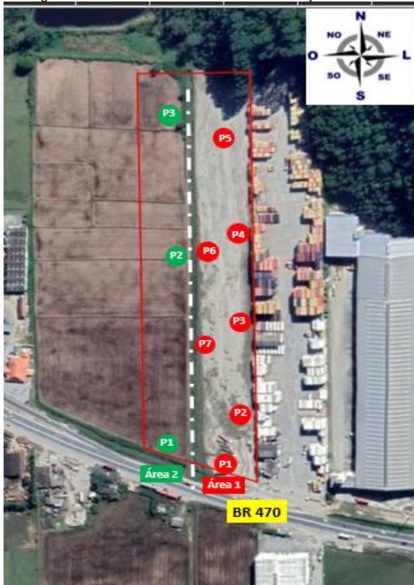
Figura 74 – Pontos onde foi realizada as medições de ruídos
