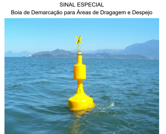
SINAL ESPECIAL Boia de Demarcação para Áreas de Dragagem e Despejo
