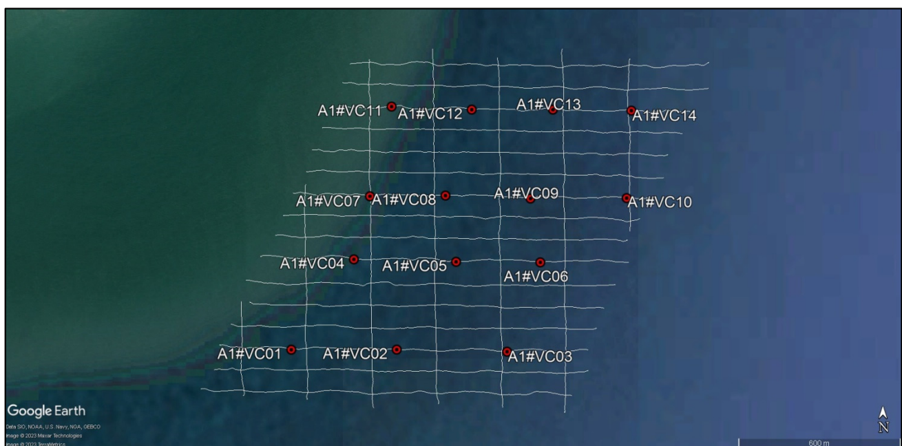
Figura 111: Localização dos 14 pontos de sondagem vibracore realizados na Área Sul, com referência às linhas de sísmica rasa executadas.
