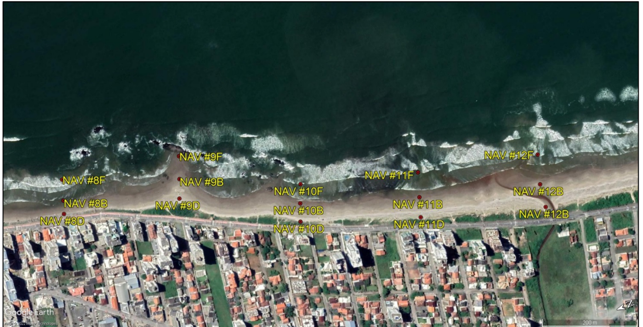
Figura 48. Posições ao longo dos perfis de praia, nas quais foram coletadas as amostras de sedimentos na Praia do Gravatá. Perfil 8 ao 12.
