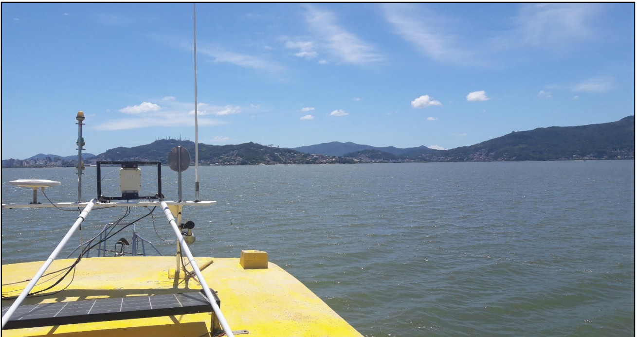
Figura 115: Sistema de posicionamento DGPS da embarcação.
