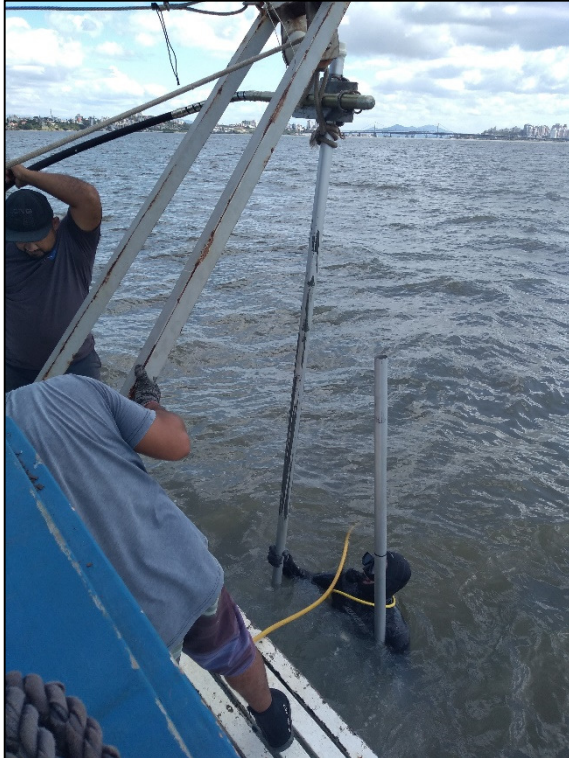
Figura 114: Equipe de mergulho durante operação (painel esquerdo) e auxílio a bordo para manter o tubo na posição vertical (painel direito).
