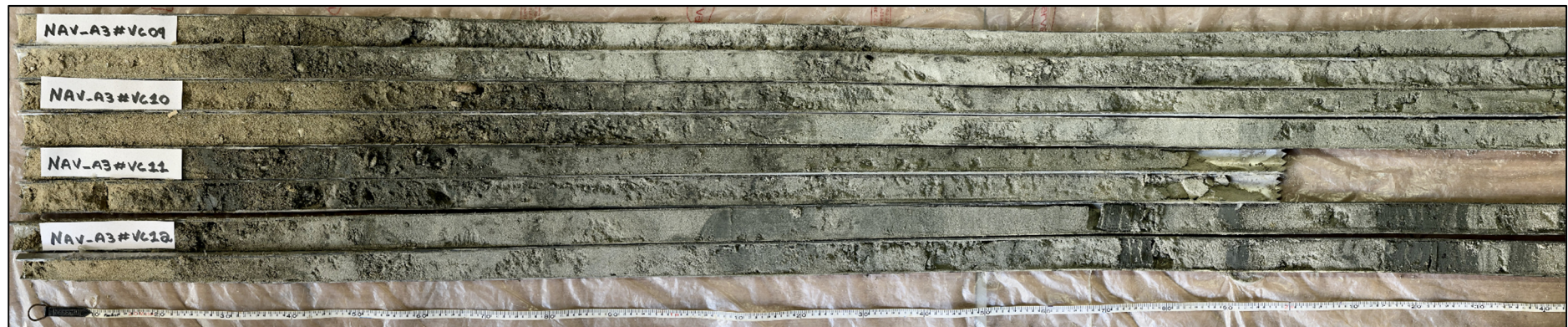
Figura 172: Fotografia das amostras vibracore #09 à #12, coletadas na Área Norte. 0-243 cm.
