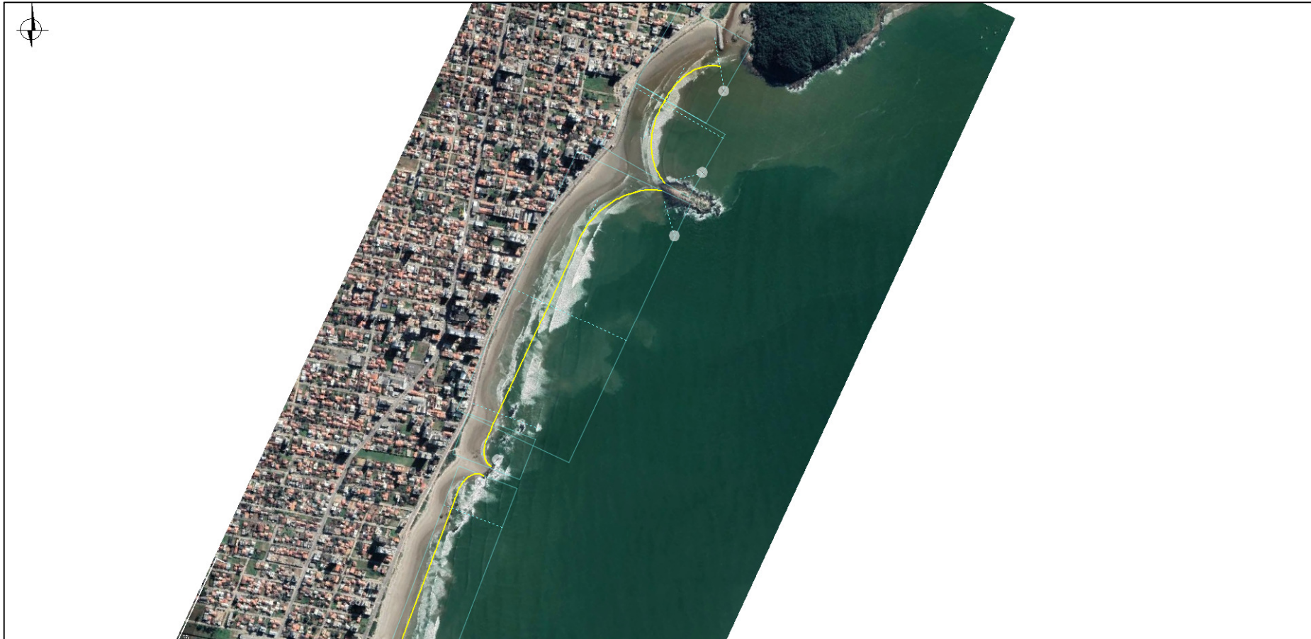
Figura 186: Vista geral da forma em planta de equilíbrio da Praia do Gravatá, estimada a partir do ajuste do modelo parabólico de Hsu e Evans (1989). A linha amarela corresponde à linha de costa projetada.
