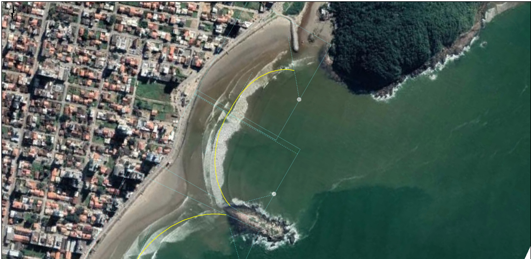
Figura 187: Forma em planta de equilíbrio estimada a partir do modelo parabólico de Hsu e Evans (1989), com detalhe na sub-unidade fisiográfica localizada entre a desembocadura do Rio Gravatá e a Ilha do Gravatá. A linha amarela corresponde à linha de costa estimada.
