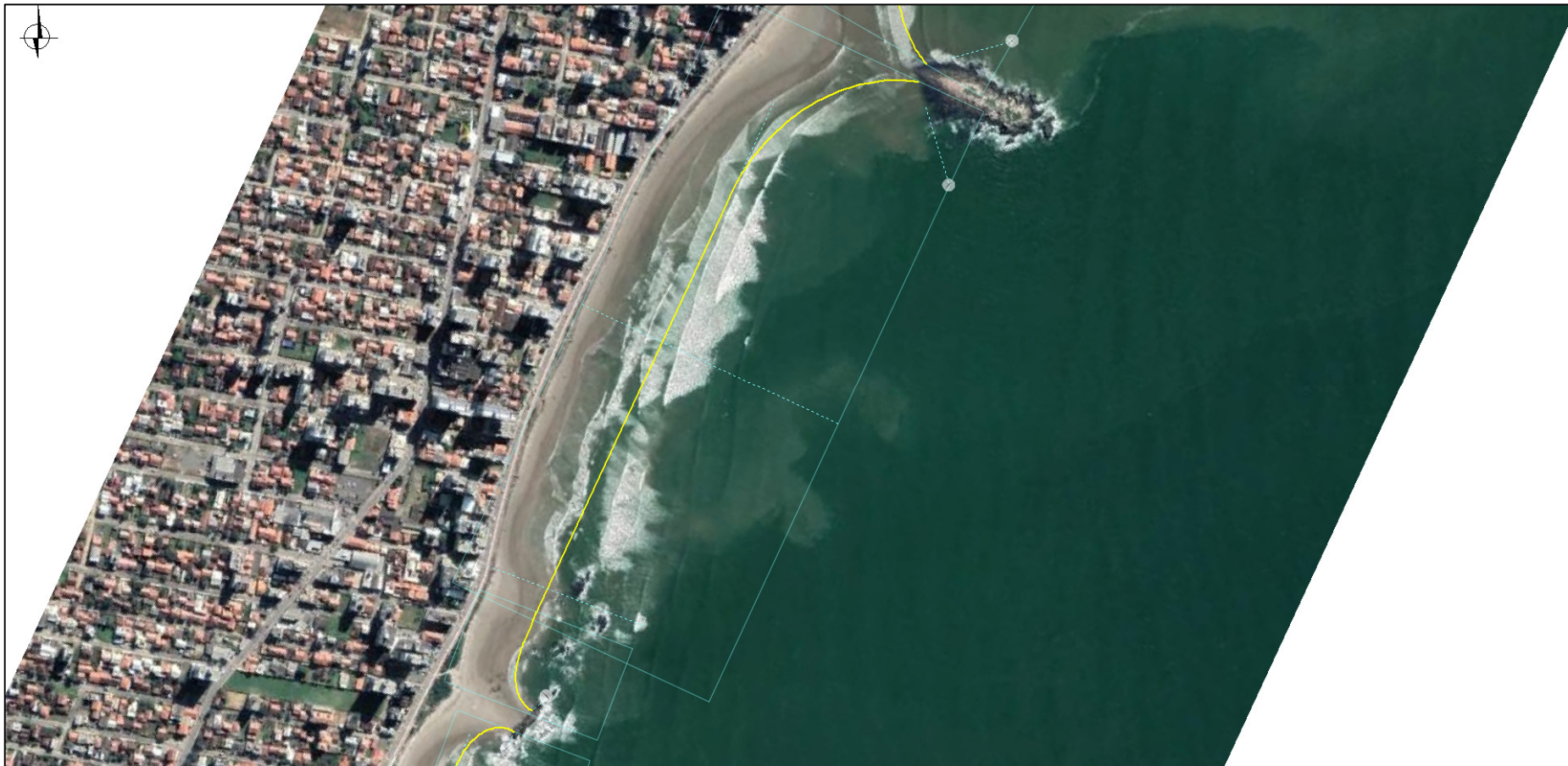
Figura 188: Forma em planta de equilíbrio estimada a partir do modelo parabólico de Hsu e Evans (1989), com detalhe na sub-unidade fisiográfica localizada entre a Ilha do Gravatá e a Pedra da Miraguaia. A linha amarela corresponde à linha de costa estimada.
