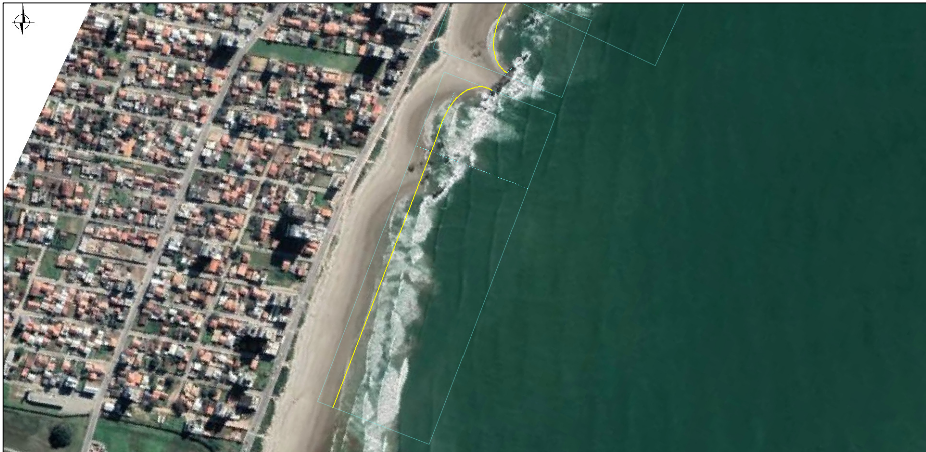
Figura 189: Forma em planta de equilíbrio estimada a partir do modelo parabólico de Hsu e Evans (1989), com detalhe na sub-unidade fisiográfica localizada entre a Pedra da Miraguaia e o Ribeirão das Pedras. A linha amarela corresponde à linha de costa estimada.
