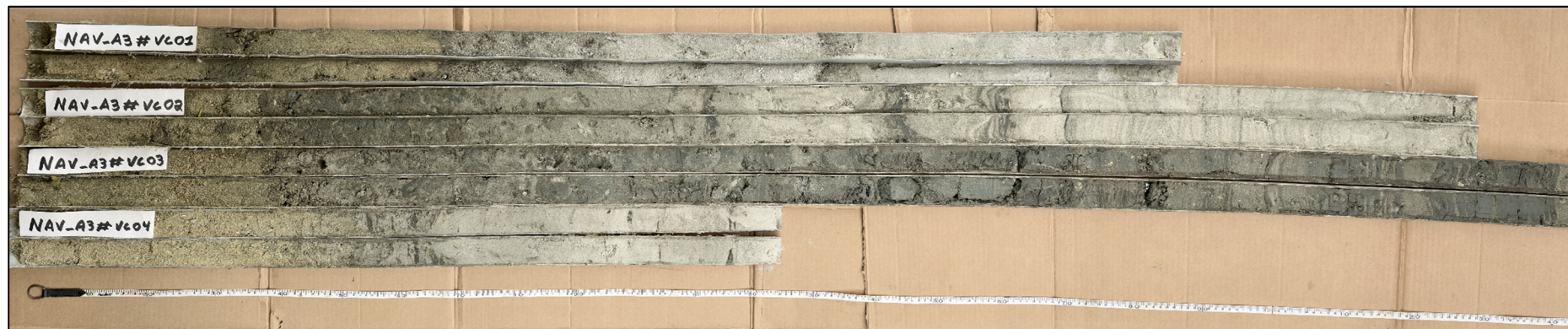
Figura 170: Fotografia das amostras vibracore #01 à #04, coletadas na Área Norte. 0-244 cm.
