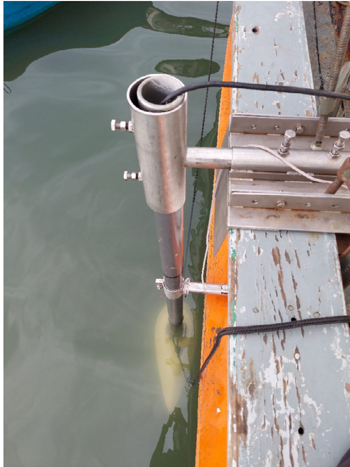
Figura 58: Perfilador de fundo CHIRP instalado na embarcação.
