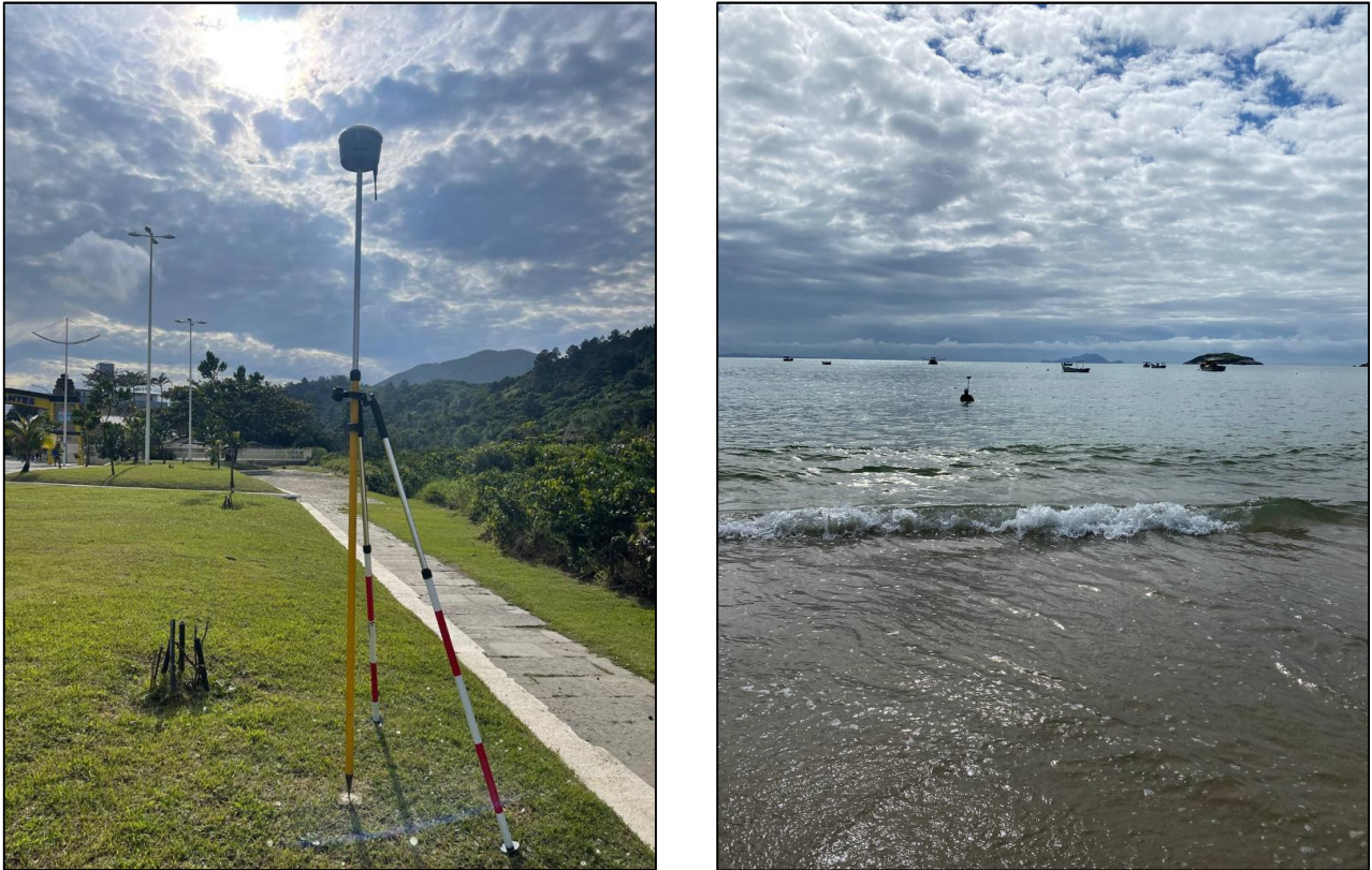
Figura 12: Instalação da Base do RTK-GPS sobre o marco de apoio topográfico implantado na praia (painel esquerdo) e medições por caminhamento com controladora e Rover, até profundidade permissível (painel direito).
