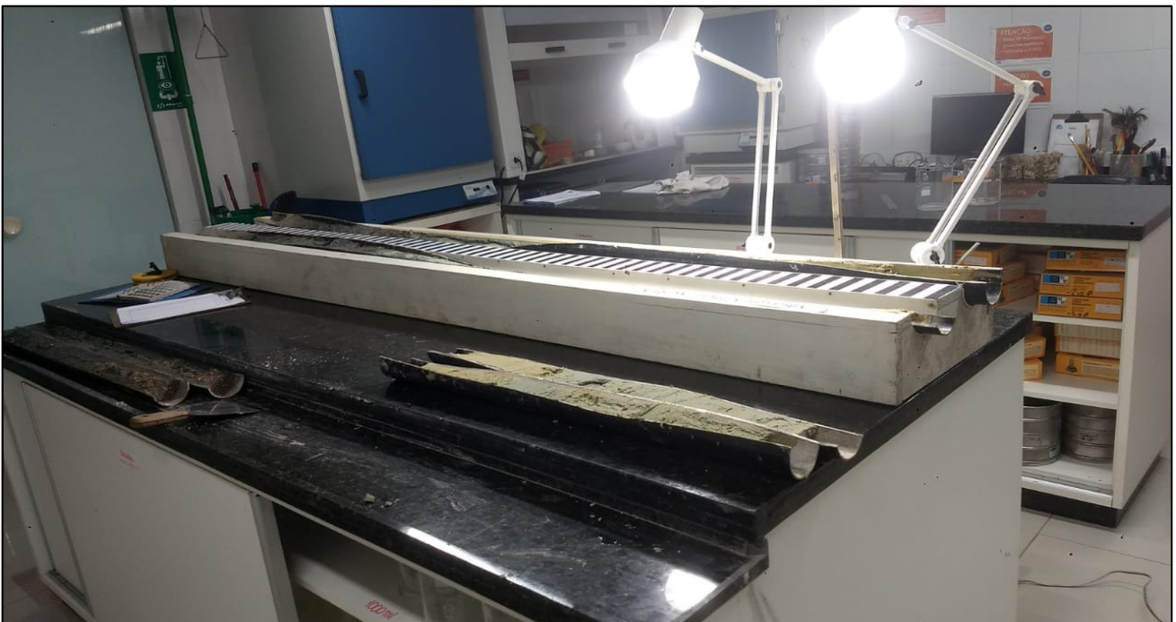
Figura 118: Aparato com iluminação e câmera para fotografia dos cores.
