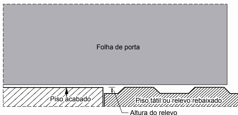
Figura 83 – Detalhe do piso tátil rebaixado
