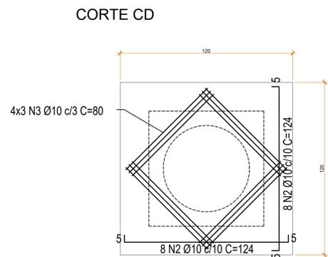
DETALHE DA TAMPA EM CONCRETO ARMADO
