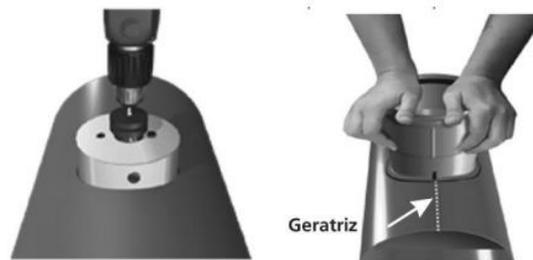
*Figura 2 – Ligação de esgoto predial no tubo corrugado*
