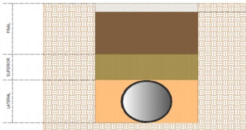
*Figura 1 - Camadas de reaterro conforme NBR 7367*
