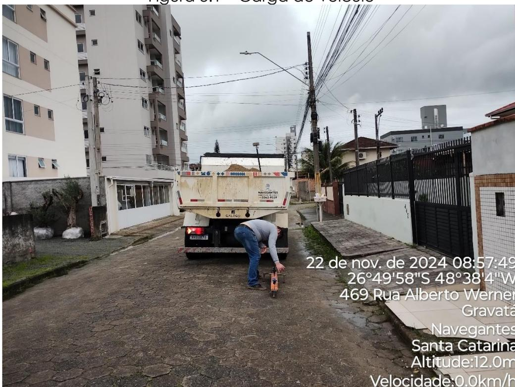
Figura 3.2 – Posicionamento viga Benkelman
